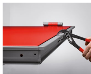
Rimozione coprifilo inferiore
