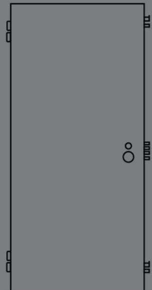
Versione "C": Serratura a cilindro a leve, Deviatori superiori ed inferiori doppi. Disponibile versione CI con serratura a ingranaggi. Sistema di blocco della serratura in caso di espulsione forzata del cilindro disponibile come optional.
